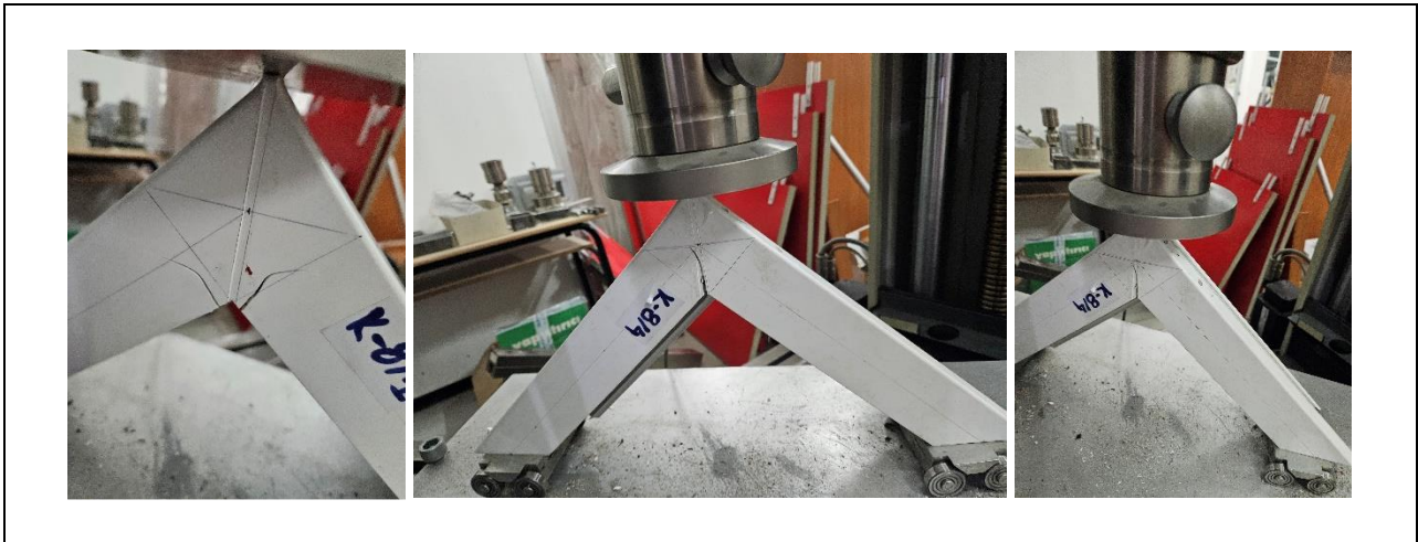
Слика 29 Делување на сила кај примероци од група крило
