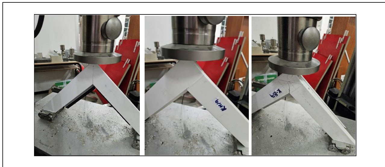
Слика 37 Делување на сила кај примероци од група крило
