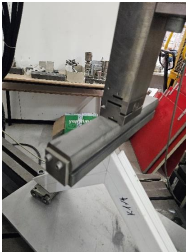
Слика 13 Нанесување на притисок со брзина 50 \pm 5 mm/min
