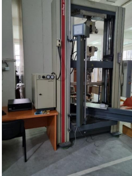
Слика 4 Zwick/Roell модел SC-FR250SW.A4K.001
