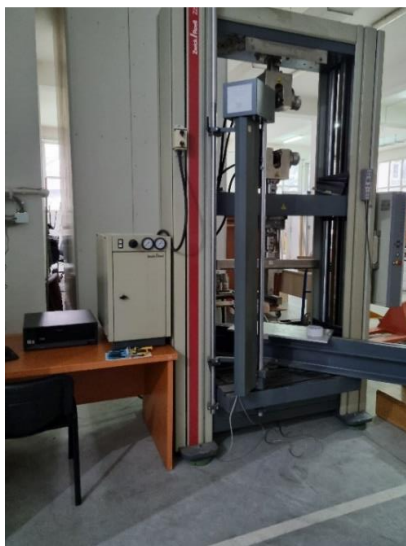
Слика 2 Zwick/Roell модел SC-FR250SW.A4K.001
