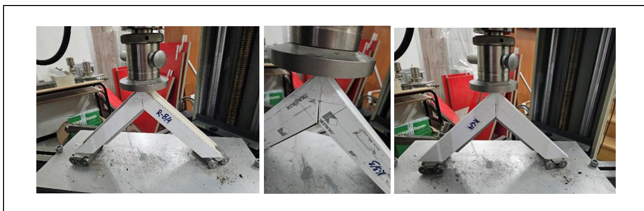
Слика 33 Делување на сила кај примероци од група крило
