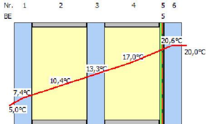
Слика 19 Стакло пакет - 4 mm Planiclear / 12 mm (Argon 90%) / 4 mm Planiclear / 12 mm (Argon 90%) / 4 mm Planiclear
