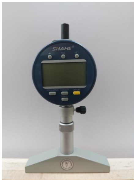
Слика 11. Дигитален компаратор тип SHAHE
