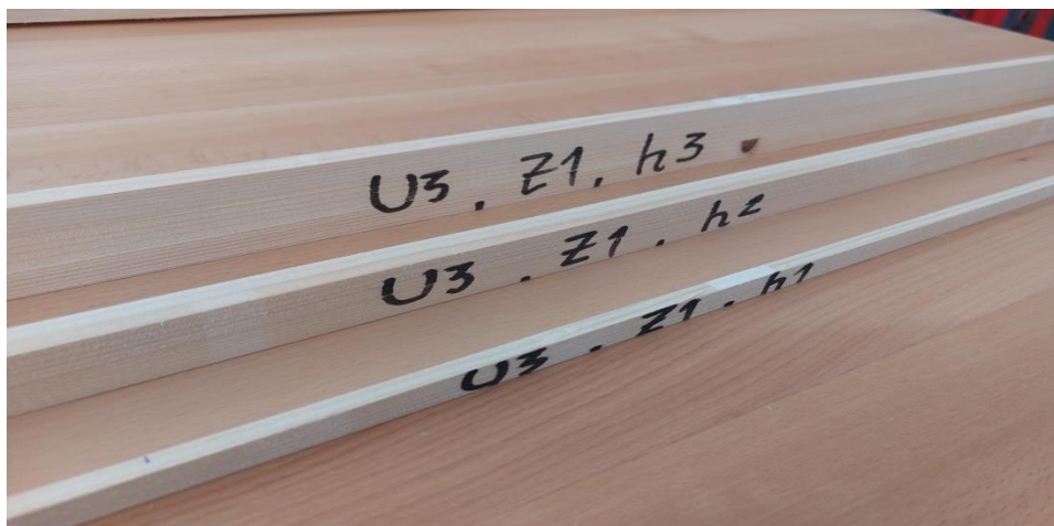
Слика 26. Проби од ЧАМ добиени при брзина на поместување U_3=20 \text{ mm} \cdot \text{min}^{-1} , број на заби од кружната пила Z_1=40 , за височини на режење h_1=15\text{mm} , h_2=30\text{mm} и h_3=45\text{mm}
