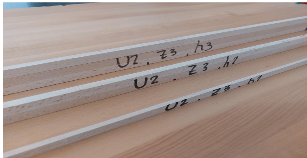
Слика 15. Проби од БУКА добиени при брзина на поместување U_2=16 \text{ mmin}^{-1} , број на заби од кружната пила Z_2=40 , за височини на режење h_1=15\text{mm} , h_2=30\text{mm} и h_3=45\text{mm}
