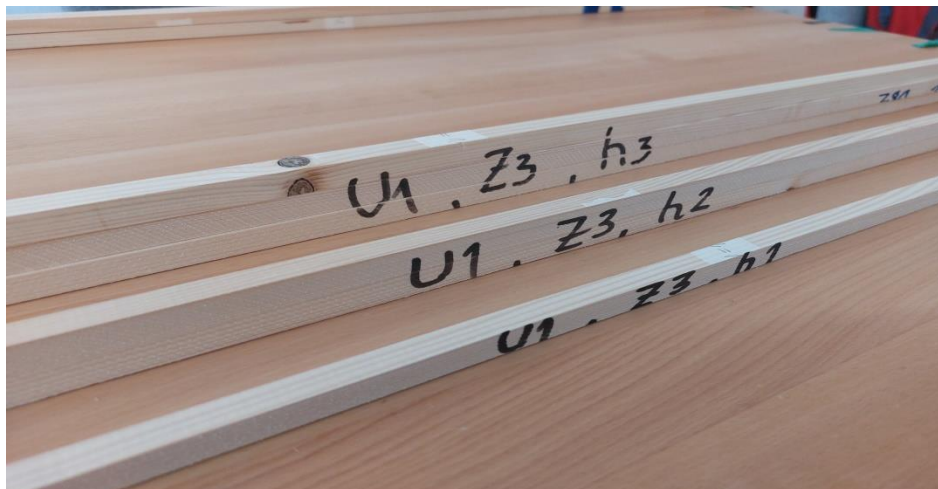
Слика 22. Проби од ЧАМ добиени при брзина на поместување U_1=12 \text{ mmmin}^{-1} , број на заби од кружната пила Z_3=80 , за височини на режење h_1=15\text{mm} , h_2=30\text{mm} и h_3=45\text{mm}
