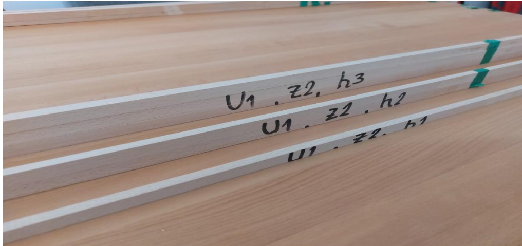
Слика 12. Проби од БУКА добиени при брзина на поместување U_1=12 \text{ mmin}^{-1} , број на заби од кружната пила Z_2=60 , за височини на режење h_1=15\text{mm} , h_2=30\text{mm} и h_3=45\text{mm}
