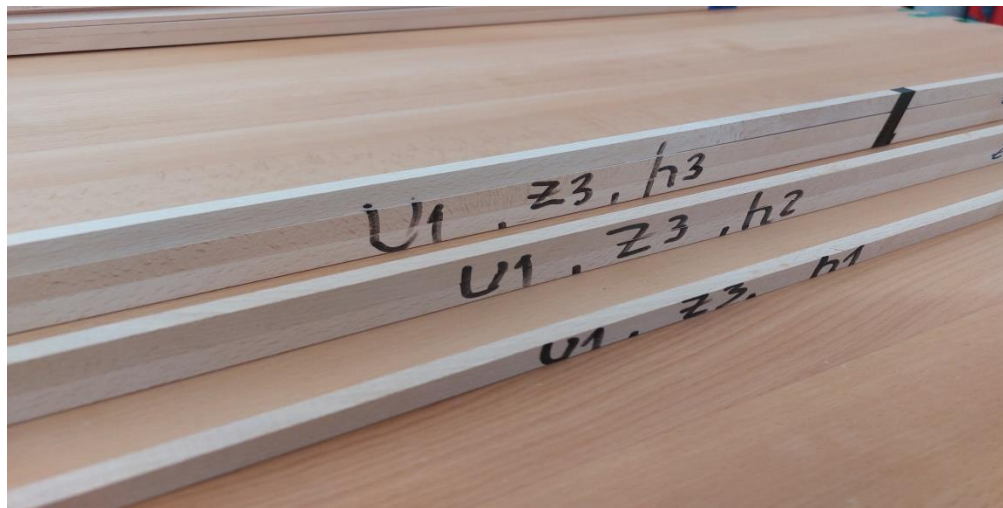
Слика 13. Проби од БУКА добиени при брзина на поместување U_1=12 \text{ mmin}^{-1} , број на заби од кружната пила Z_3=80 , за височини на режење h_1=15\text{mm} , h_2=30\text{mm} и h_3=45\text{mm}
