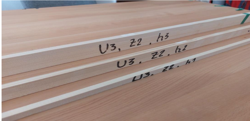
Слика 27. Проби од ЧАМ добиени при брзина на поместување U_3=20 \text{ mmmin}^{-1} , број на заби од кружната пила Z_2=60 , за височини на режење h_1=15\text{mm} , h_2=30\text{mm} и h_3=45\text{mm}
