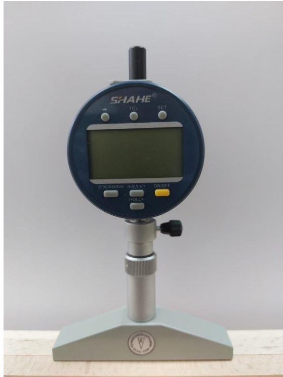
Слика 30. Дигитален компаратор тип SHAHE
