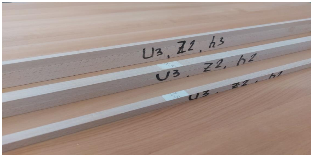
Слика 18. Проби од БУКА добиени при брзина на поместување U_3=20 \text{ mmmin}^{-1} , број на заби од кружната пила Z_2=60 , за височини на режење h_1=15\text{mm} , h_2=30\text{mm} и h_3=45\text{mm}
