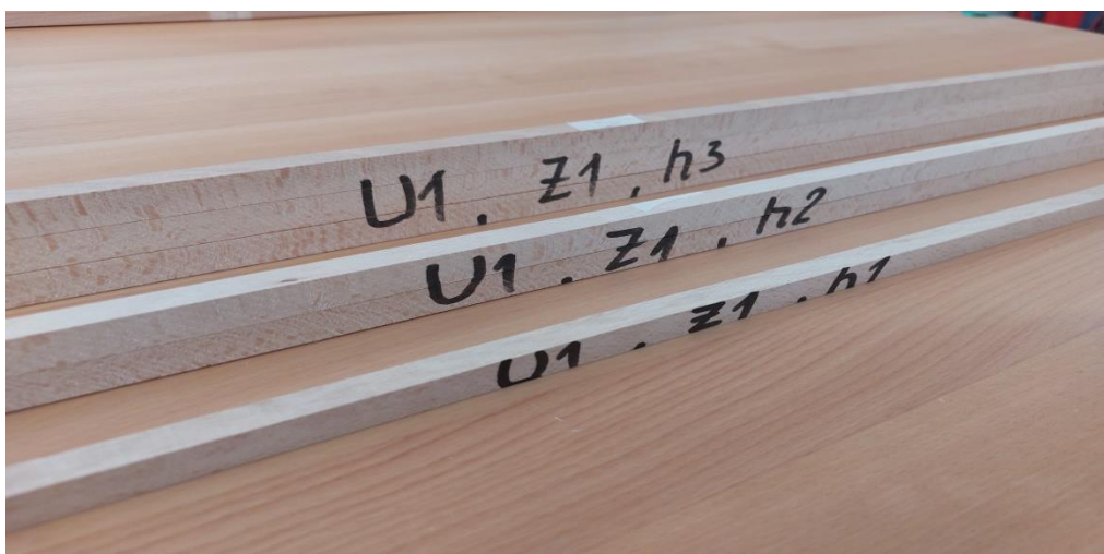
Слика 8. Проби од БУКА добиени при брзина на поместување U_1=12 \text{ mmmin}^{-1} , број на заби од кружната пила Z_1=40 , за височини на режење h_1=15\text{mm} , h_2=30\text{mm} и h_3=45\text{mm}
