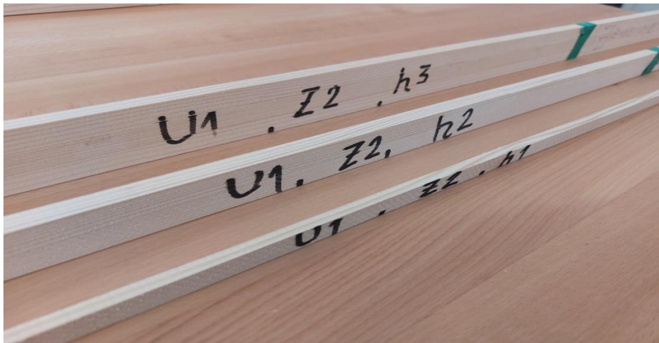
Слика 20. Проби од ЧАМ добиени при брзина на поместување U_1=12 \text{ mm} \cdot \text{min}^{-1} , број на заби од кружната пила Z_1=40 , за височини на режење h_1=15\text{mm} , h_2=30\text{mm} и h_3=45\text{mm}
