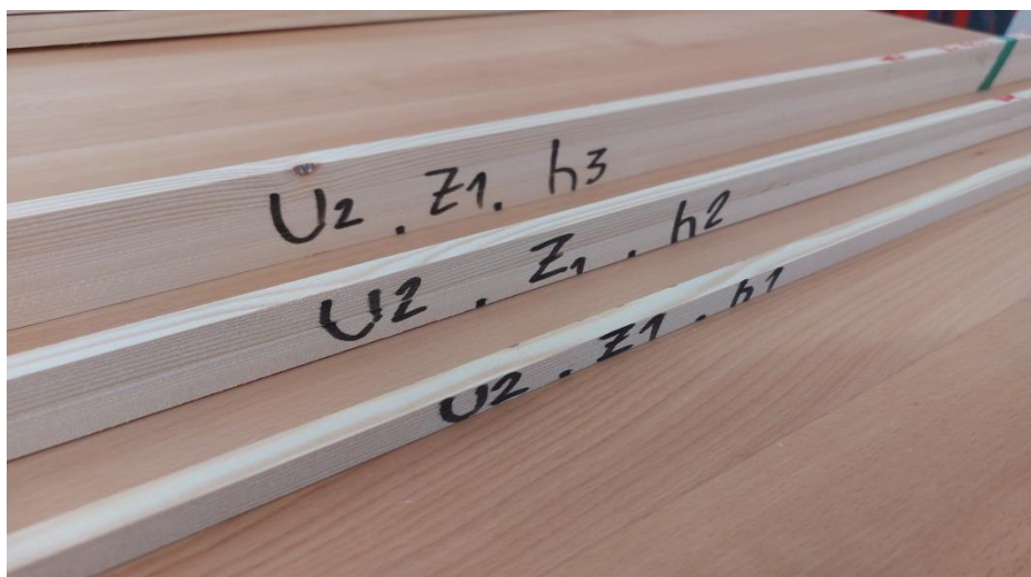
Слика 23. Проби од ЧАМ добиени при брзина на поместување U_2=16 \text{ mmmin}^{-1} , број на заби од кружната пила Z_3=40 , за височини на режење h_1=15\text{mm} , h_2=30\text{mm} и h_3=45\text{mm}
