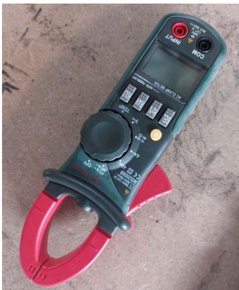
Слика 12. Напонска клешта тип MASTECH MS 2008В
