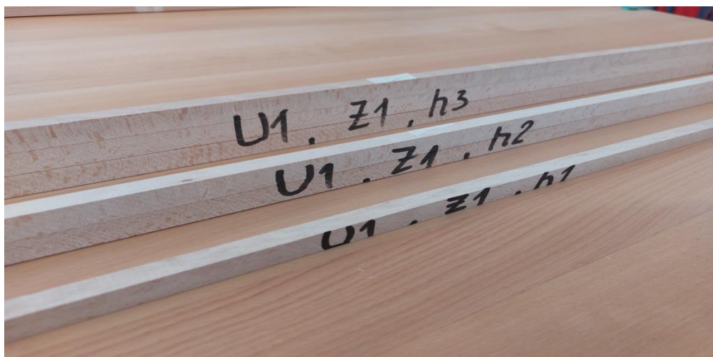
Слика 11. Проби од БУКА добиени при брзина на поместување U_1=12 \text{ mmmin}^{-1} , број на заби од кружната пила Z_1=40 , за височини на режење h_1=15\text{mm} , h_2=30\text{mm} и h_3=45\text{mm}
