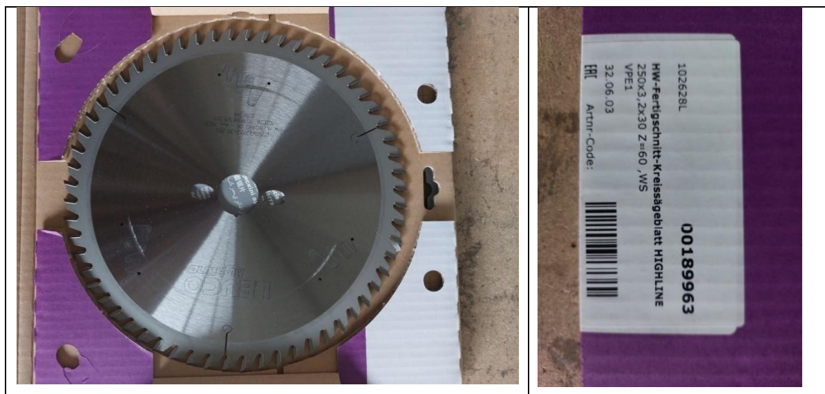
Слика 6. Кружна пила со дијаметар D=250\text{mm} , дебелина 3,2\text{mm} и број на заби Z_2=60
