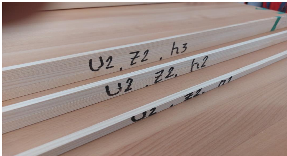
Слика 24. Проби од ЧАМ добиени при брзина на поместување U_2=16 \text{ mm} \cdot \text{min}^{-1} , број на заби од кружната пила Z_3=60 , за височини на режење h_1=15\text{mm} , h_2=30\text{mm} и h_3=45\text{mm}
