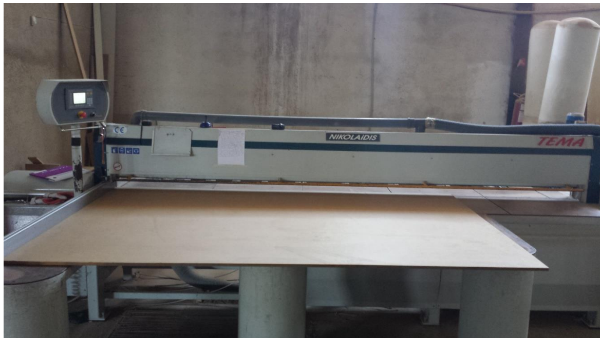
Слика 1. Изглед на основната машина-форматна кружна пила од грчко потекло: NIKOLAIDIS TEMA 3800
