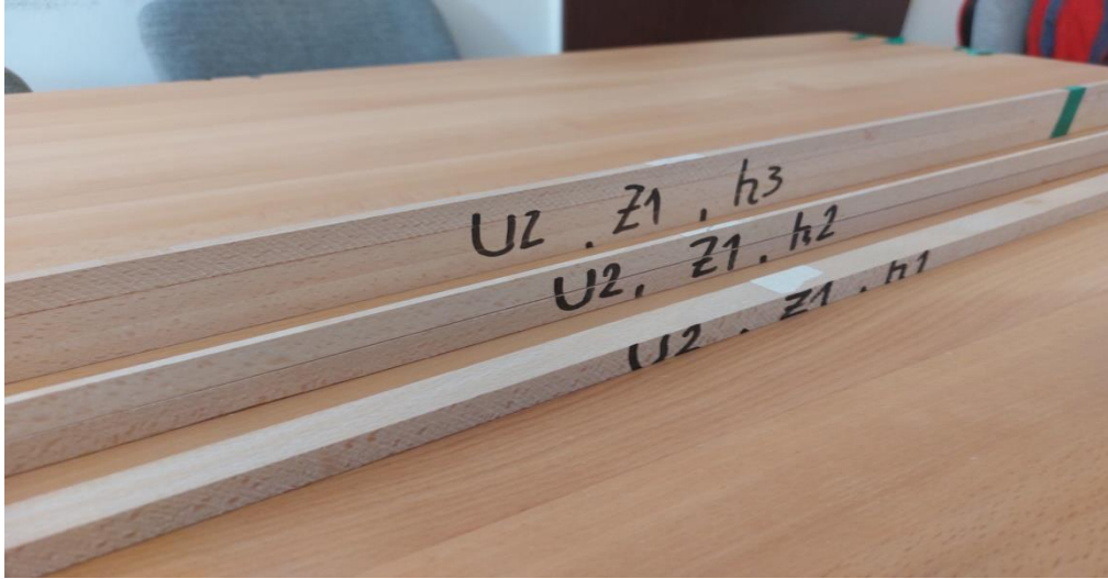
Слика 14. Проби од БУКА добиени при брзина на поместување U_2=16 \text{ mmin}^{-1} , број на заби од кружната пила Z_1=40 , за височини на режење h_1=15\text{mm} , h_2=30\text{mm} и h_3=45\text{mm}
