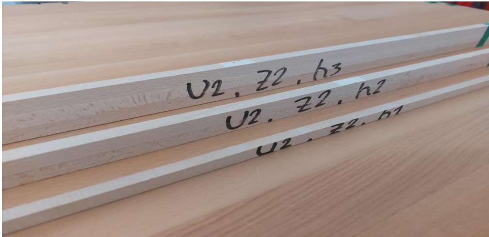
Слика 15. Проби од БУКА добиени при брзина на поместување U_2=16 \text{ mmin}^{-1} , број на заби од кружната пила Z_2=40 , за височини на режење h_1=15\text{mm} , h_2=30\text{mm} и h_3=45\text{mm}
