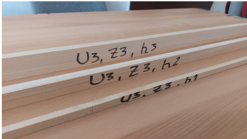
Слика 28. Проби од ЧАМ добиени при брзина на поместување U_3=20 \text{ mmmin}^{-1} , број на заби од кружната пила Z_2=80 , за височини на режење h_1=15\text{mm} , h_2=30\text{mm} и h_3=45\text{mm}
