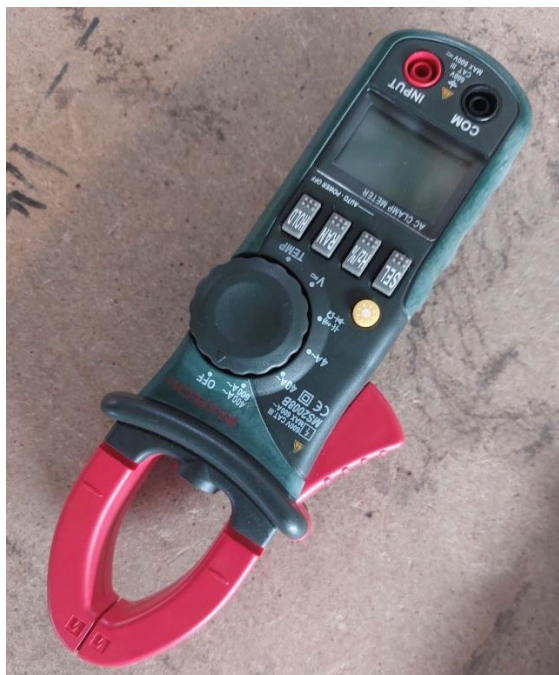
Слика 31. Напонска клешта тип MASTECH MS 2008B
