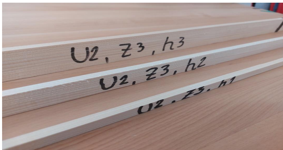
Слика 25. Проби од ЧАМ добиени при брзина на поместување U_2=16 \text{ mm} \cdot \text{min}^{-1} , број на заби од кружната пила Z_3=80 , за височини на режење h_1=15\text{mm} , h_2=30\text{mm} и h_3=45\text{mm}
