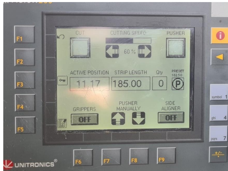
Слика 2 . Инструмент табла со контролен дисплеј на форматната кружна пила Nikolaidis TEMA 3800
