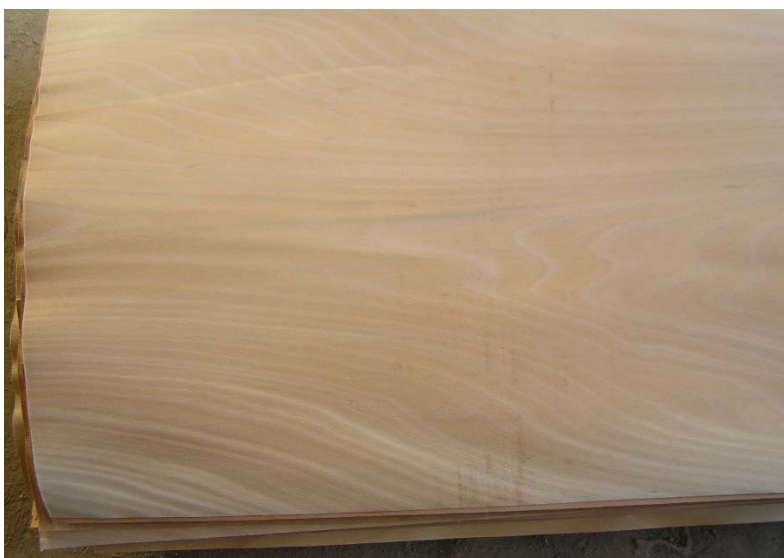
Слика 1. Изглед на буквите фурнирски листови користени за изработка на експерименталниот модел на multiplex фурнирска плоча
