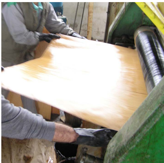
Слика 6. Нанесување на лепило врз фурнирските листови на машина за нанесување на лепило „Friz-Stuttgart-Wild&Lucke“
